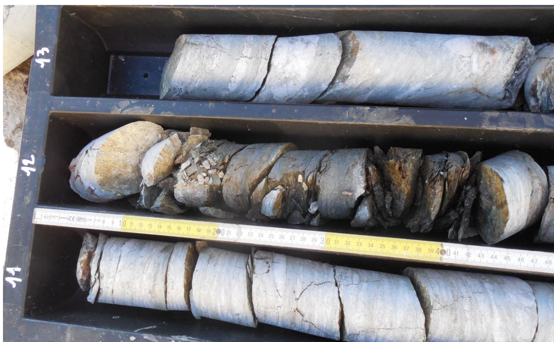
Livello fratturato in S2, l'alterazione risulta meno marcata che nel sondaggio S1.
