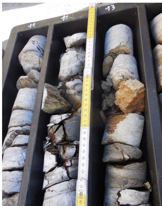
Livelli intensamente fratturati con marcata alterazione nel sondaggio S1.
