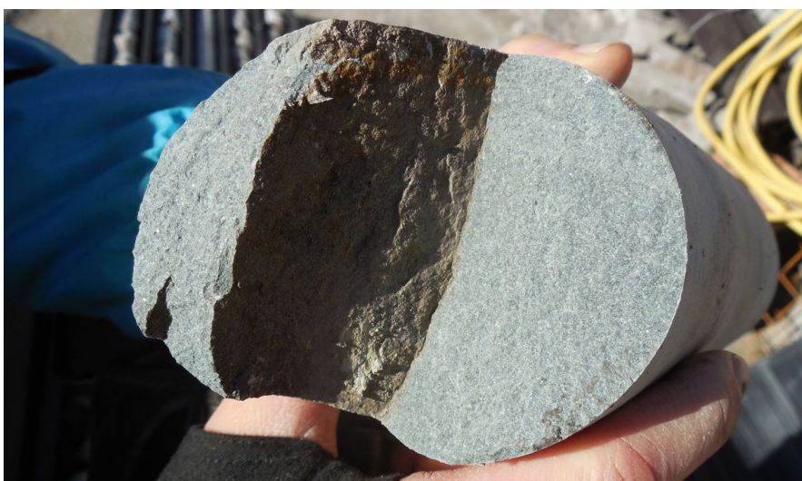
Filone intrusivo a fine sondaggio S2.
